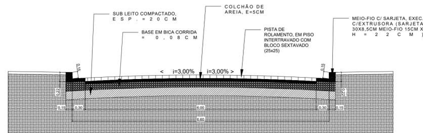
SEÇÃO TIPO (PAV. EM PISO INTERTRAVADO)
